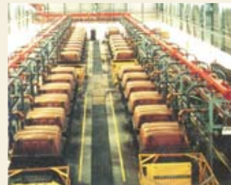
隔膜法の電解槽(尼崎工場 昭和51年)
