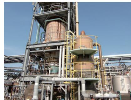
排水熱分解による有機物回収設備(松山工場)
